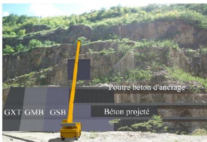
Figure 3. Schéma conceptuel de la pose des géosynthétiques sur le parement.
