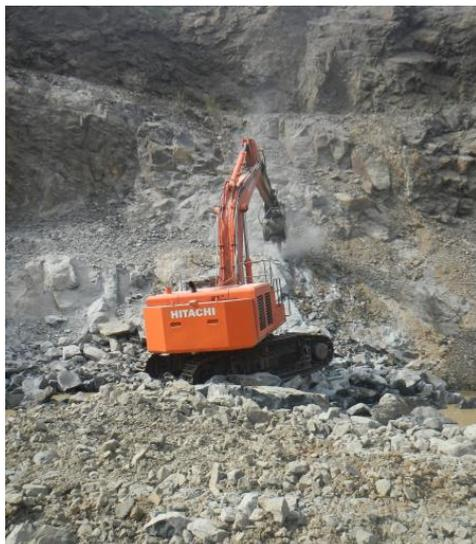
Figure 2. Travail au BRH sur l'andésite en parement.
